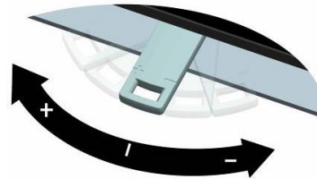
Fig. 4: régler l'arrivée d'air
