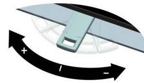
Fig. 4: Regolazione della levetta dell'aria
